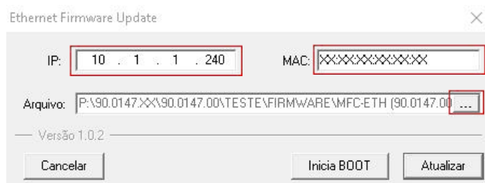
Figura 16 - Exemplo de atualização de firmware via Ethernet.
